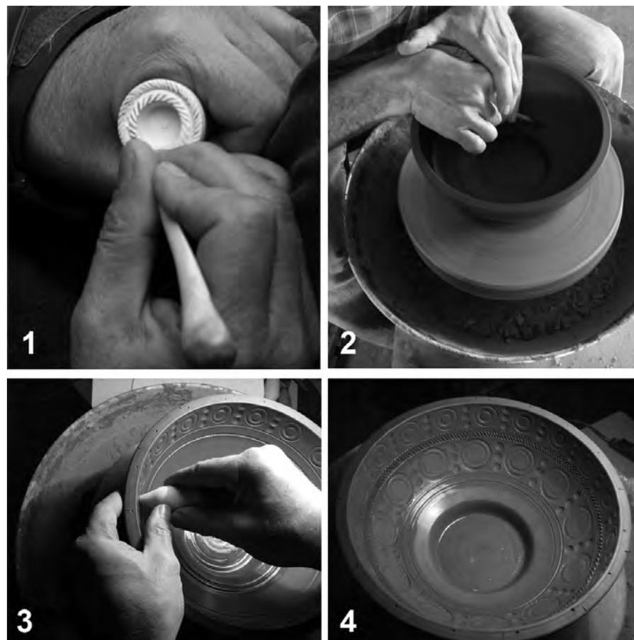
Fig. 01. Fabricación del molde.
